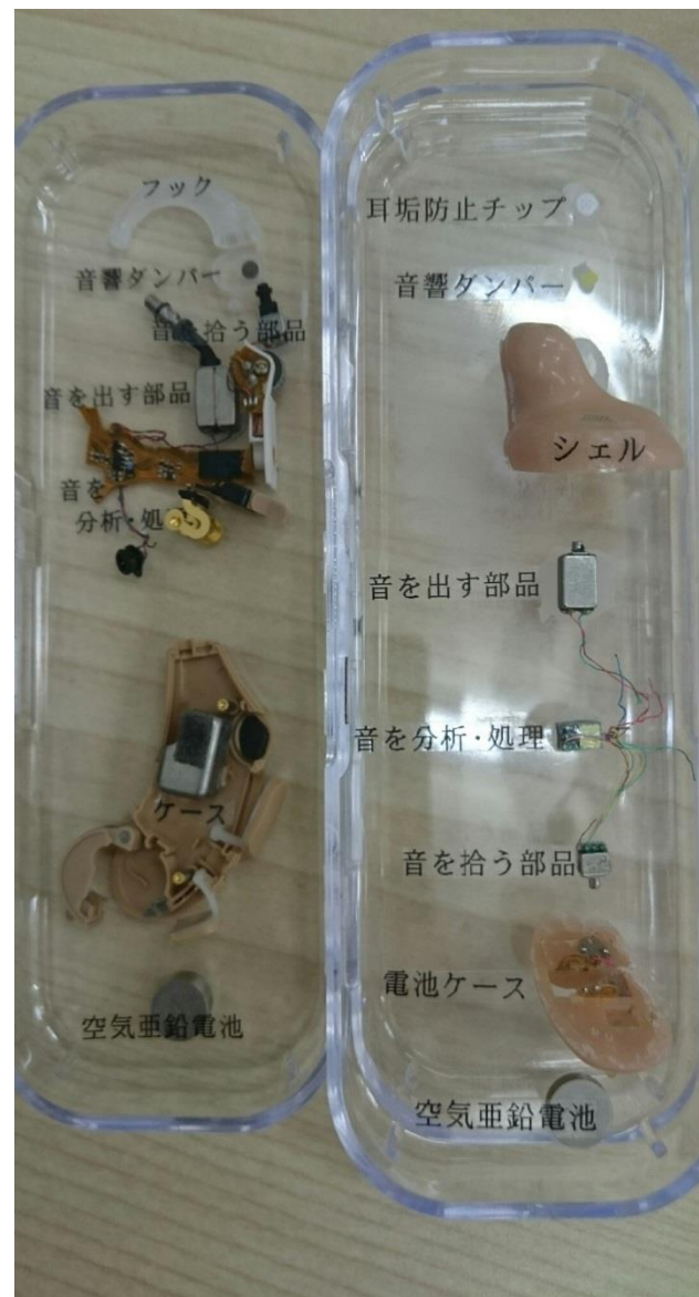
耳あな型と耳かけ型の分解模型
